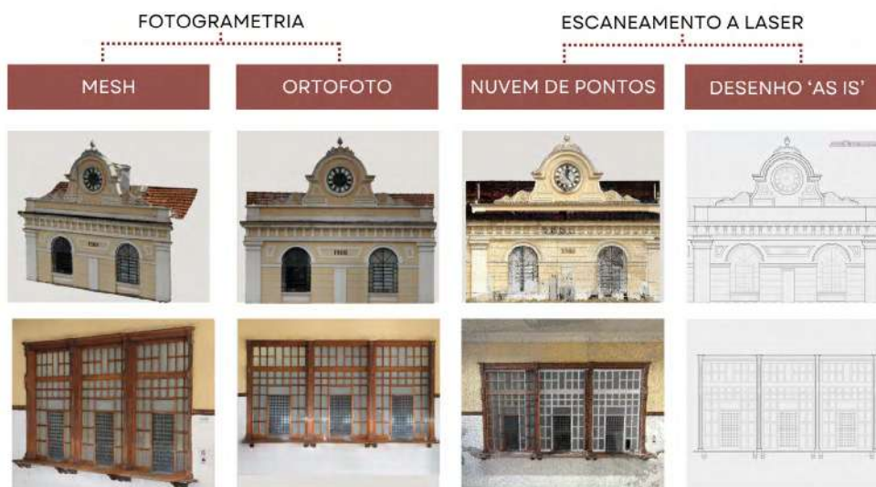
Figura 2: Esquema dos resultados finais do processo de fotogrametria e escaneamento a laser
