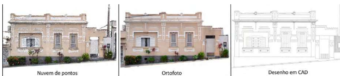
Figura 1: Produtos realizados com a fotogrametria e o escaneamento a laser
